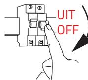
Schakel altijd eerst de stroom uit voordat u installatie-, onderhoud of reparatiewerkzaamheden uitvoert.
