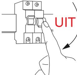
**Schakel altijd eerst de stroom uit voordat u installatie-, onderhoud of reparatiewerkzaamheden uitvoert.**
